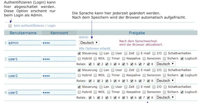
Relais/Steckdosen können für User gesperrt und werden als inaktiv (wie gesperrt in Einstellung/Schaltverhalten) dargestellt.
